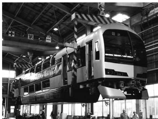
鉄道車両を吊り上げて検査している光景
